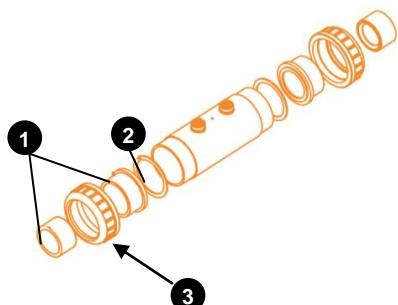
*El conjunto « tubería/célula/tubería » tiene que ser perfectamente recto si no habrá fugas de agua a la entrada y a la salida de la célula.*
