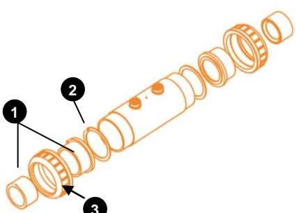
*L'ensemble canalisation/cellule/canalisation doit être parfaitement droite sous peine de fuites d'eau au niveau de l'entrée ou de la sortie de la cellule.*
