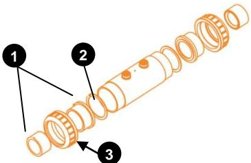
*Die Einheit Rohrleitung/Zelle/Rohrleitung muss vollkommen gerade sein, um Wasserleckagen am Zellenein- oder -ausgang zu vermeiden.*
