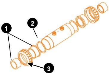
*L'insieme canalizzazione/cella/canalizzazione deve essere perfettamente dritta per evitare perdite d'acqua al livello dell'entrata e dell'uscita della cella.*
