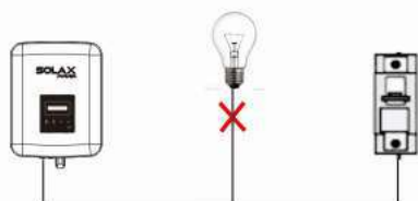
Conexión Incorrecta entre Carga e Inversor
