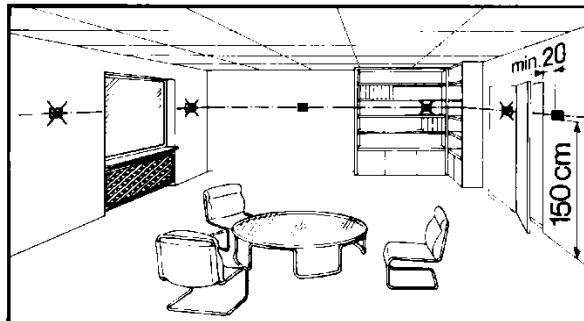
L'appareil peut être monté dans une boîte encastrée ou fixé directement au mur.
