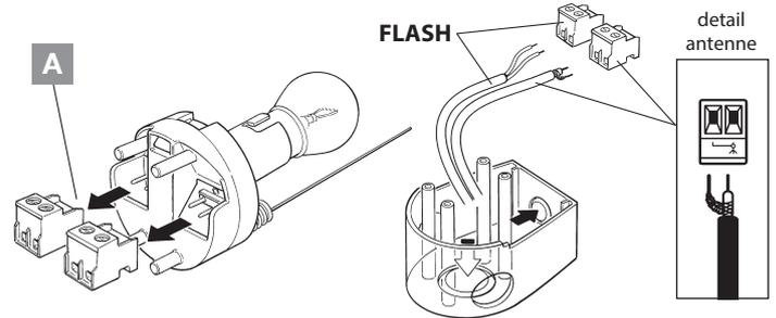
9. Enfiler la douille de la lampe dans la base en veillant à l'enfoncer à fond jusqu'à ce qu'elle se bloque.
