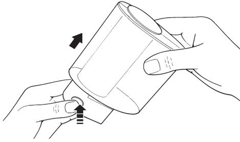
3. Séparer la douille de la lampe avec antenne de la base.
