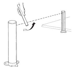
5. Effectuer la mesure de la force d'impact suivant les prescriptions de la norme EN 12445 et éventuellement si le contrôle de la « force moteur » est utilisé comme auxiliaire du système pour la réduction de la force d'impact, essayer et trouver le réglage qui donne les meilleurs résultats.
