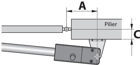
3. En fonction de la valeur de « C » et de l'angle d'ouverture désiré des battants, on peut trouver dans le **Tableau 6** la valeur de « A » (distance entre le centre de la fixation sur le pilier et l'axe de rotation du portail). • **EXEMPLE** : si l'on désire un angle d'ouverture de 90° et la valeur « C » est de 70 mm, la valeur de « A » devra être de 130 mm.
