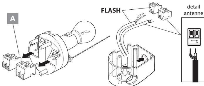
9. Enfiler la douille de la lampe dans la base en veillant à l'enfoncer à fond jusqu'à ce qu'elle se bloque.
