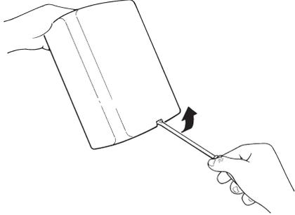
3. Prévoir le conduit pour le passage des câbles électriques de manière qu'ils puissent entrer dans l'armoire par la partie inférieure, comme sur la figure suivante.
