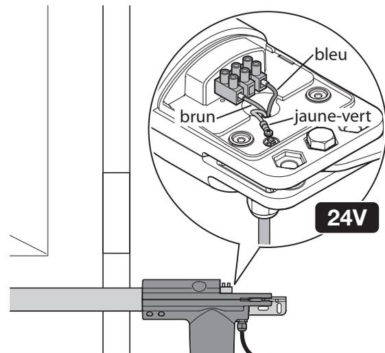
16. Serrer le serre-câble [A] et remettre le couvercle [B]. **ATTENTION !** - Le câble qui sort de l'opérateur [C] doit être courbé de manière qu'il puisse suivre le mouvement de l'opérateur.
