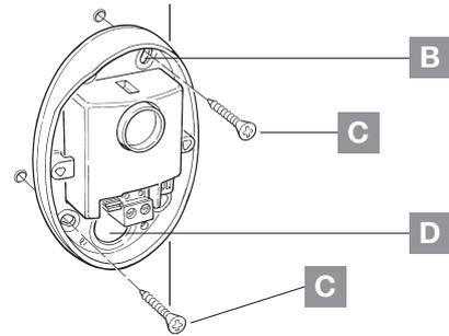
8. Connecter le câble électrique aux bornes prévues à cet effet aussi bien sur le TX que sur le RX. Du point de vue électrique, TX et RX doivent être connectés en parallèle comme le montre la figure suivante.
