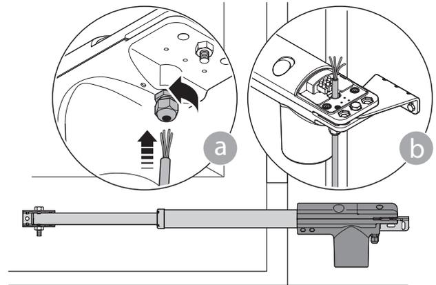
15. Raccorder les différents câbles et le câble de terre dans l'œillet prévu à cet effet.
