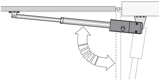
12. Décrocher la tige de la plaque avant [A] et la fixer définitivement au battant [B]. Enfin, fixer définitivement la tige à la plaque avant [D].
