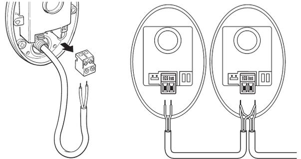
Il n'est pas nécessaire de respecter une polarité quelconque. Pour faciliter les opérations, il est possible d'enlever les bornes ; effectuer les connexions puis les remettre en place.
