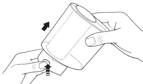
3. Séparer la douille de la lampe avec antenne de la base.
