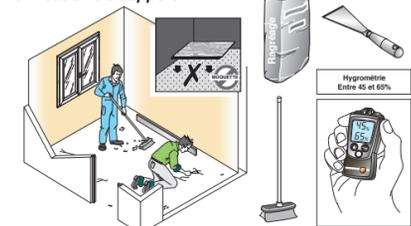
Le parquet doit être posé sur un support adéquat. Ce support doit être :
