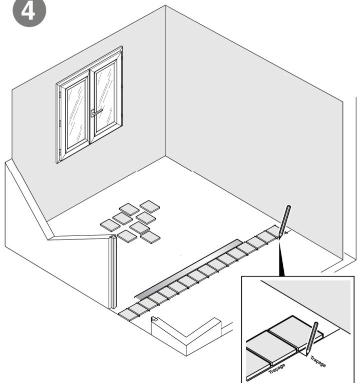
Vérifiez le bon alignement avec la règle métallique et faites un repère au sol à l'aide d'un crayon au niveau du dernier carreau.
