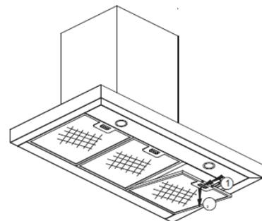
Les filtres doivent être lavés séparément des couverts et des ustensiles de cuisine. Il est conseillé de ne pas utiliser un agent de rinçage.
