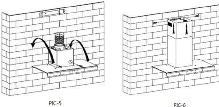
5. Réglez la hauteur de la cheminée intérieure sur la position de l'étrier de la cheminée intérieure et fixez-la au moyen d'une vis, après avoir réglé la position, fixez le bloc avec une vis d'arrêt. Voir fig. 6.
