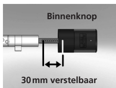
Schematische weergave binnenknop-verstelling
