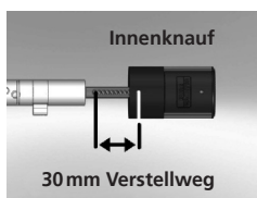
Schematische Darstellung Innenknauf-Verstellung
