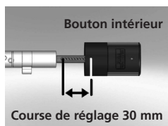
Représentation schématique Réglage bouton intérieur
