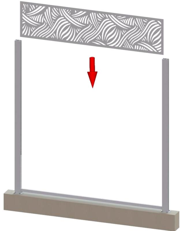
**Etape 6 :** Faites glisser un profil claustra jusqu'à être en appui sur les clososirs tôle
