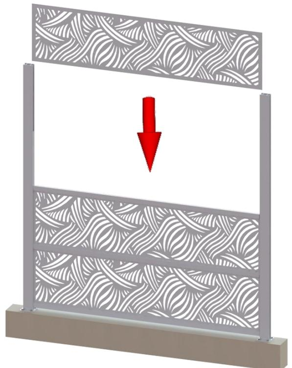
**Etape 12 :** Faites glisser un profil claustra jusqu'à être en appui sur les closoirs tôle
