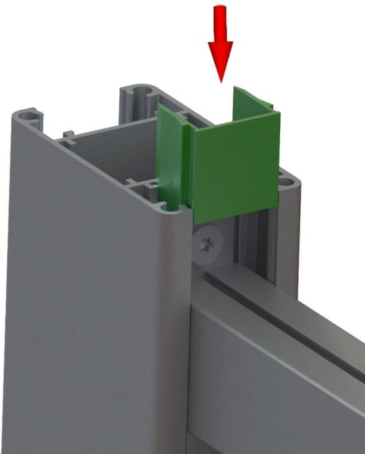
**Etape 19 :** Mettez en place le profil U finition (coupé à la longueur de l'entre poteaux à l'aide d'une scie à métaux) et le coller avec des points silicone au dessus du profil Claustra
