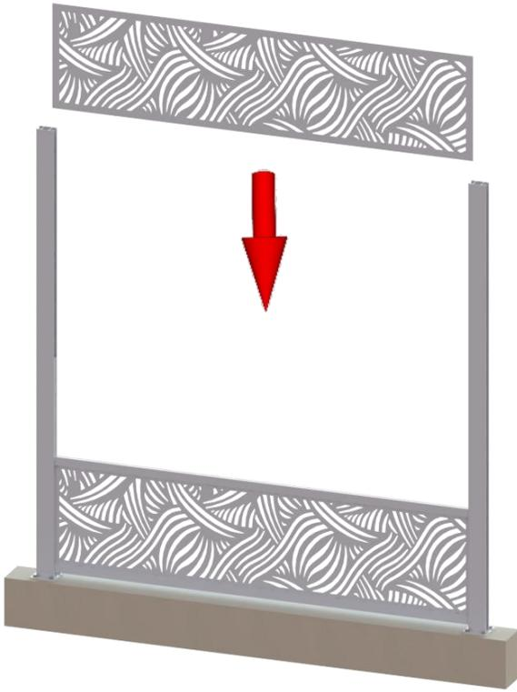
**Etape 9 :** Faites glisser un profil claustra jusqu'à être en appui sur les closoirs tôle
