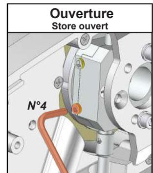
**Fin de course :** Actionner la vis vers le «+» pour plus de fermeture ou d'ouverture, vers le «-» pour moins fermeture ou d'ouverture.
