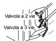
7. Per evitare le perdite di gas, ruotare il tappo della porta di servizio della valvola a 2 vie e di quello della valvola a 3 vie un po' oltre il punto di serraggio, in cui la resistenza aumenta immediatamente.
