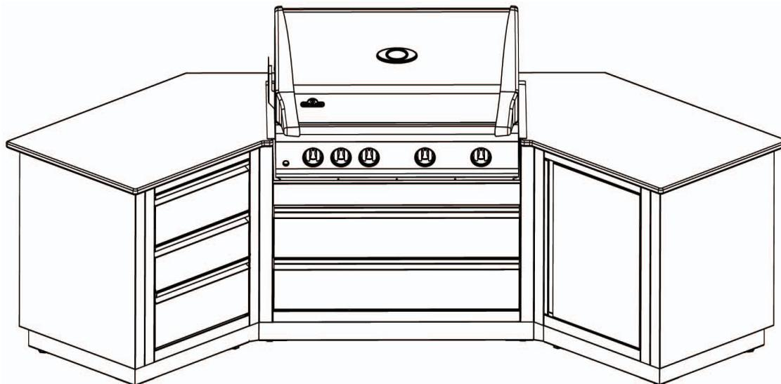
La configuration ci-dessus montre un îlot isolé. Ci-dessous, les lignes pointillées indiquent le périmètre du comptoir (non fourni). L'unité est mise en angle grâce à l'ensemble IM-45T d'un côté ou l'autre de l'unité, ce qui permet de faire pivoter le cabinet latéral de 45 degrés. Le panneau d'extrémité IM-CEP est aussi illustré. Ce panneau embellit la finition aux extrémités des cabinets assemblés en recouvrant les ouvertures laissées par les plaques poinçonnées et les trous de montage.
