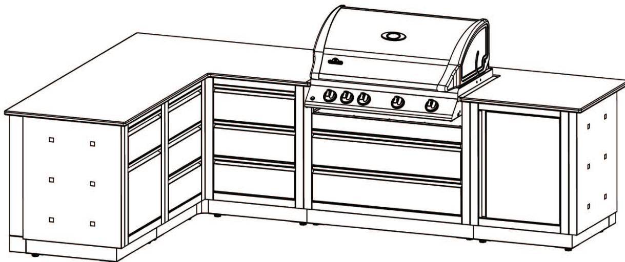
La configuration suivante montre un îlot installé contre un mur incombustible de la maison. Ci-dessous, les lignes pointillées indiquent le périmètre du comptoir (non fourni). Un ensemble d'espaceur mural IM-WF est installé à quatre endroits, ce qui laisse un jeu de 4 po (102 mm) entre l'unité et le mur pour permettre l'ouverture du couvercle du gril. **L'espacement mural WSF ne fournit pas suffisamment de dégagement pour permettre à l'appareil d'être placé contre un mur combustible.**
