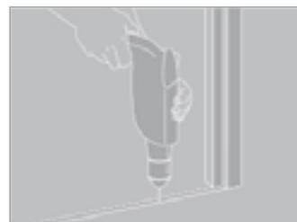
**Pour éviter d'éclater le carrelage, recouvrez les points de perçage avec deux morceaux d'adhésif transparent posés en croix.**
