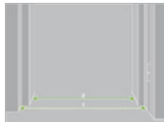
**Les barres de seuil sont proposées en différentes longueurs de 83 à 200 cm. Si la largeur du passage ne correspond pas à une taille standard, choisissez la dimension supérieure afin de la recouper.**
