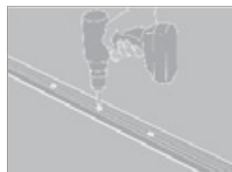
**À la visseuse, vissez de façon progressive pour ne pas abîmer les têtes des vis et les fraisages des trous en fin de course.**
