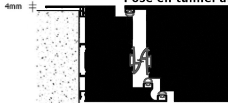
Pose en feuillure
