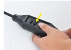
4. Presione el botón "RESET". El indicador luminoso se iluminará en rojo. La bomba está lista para su uso.
