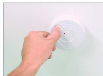
En cas de déclenchement intempestif et selon les modèles, **vous pouvez soit couper la sirène en appuyant sur le bouton «hush»...** soit ouvrir le couvercle et ôter les piles.
