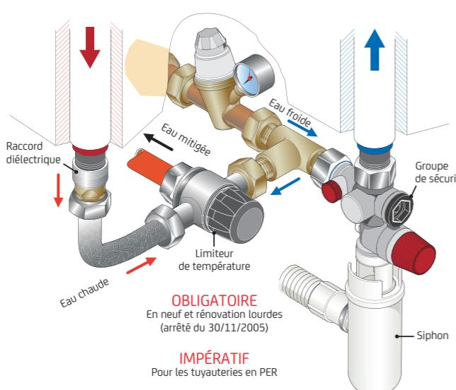
La tuyauterie doit supporter une T° de 100 °C et 10 bars. Dans le cas contraire, mettre un limiteur de température en sortie **DIRECTE** du chauffe-eau.
