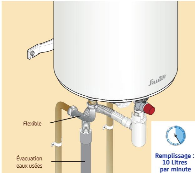
Ouvrez l'eau pour remplir le chauffe-eau et testez l'étanchéité.
