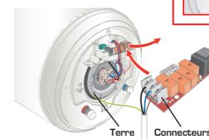
**En cas d'intervention sur le raccordement électrique, NE JAMAIS BRANCHER le CORDON D'ALIMENTATION sur la RÉSISTANCE !**
