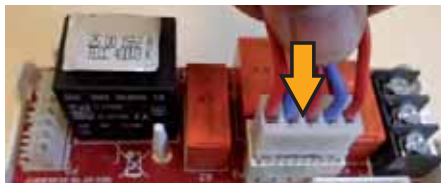
Remettre le connecteur de l'élément chauffant sur la carte puissance 400 V
