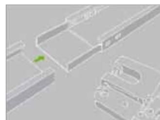
**Les fourrures se clipent en force sur les cavaliers.** L'épaisseur de l'acier galvanisé est calculée pour éviter de le déformer.
