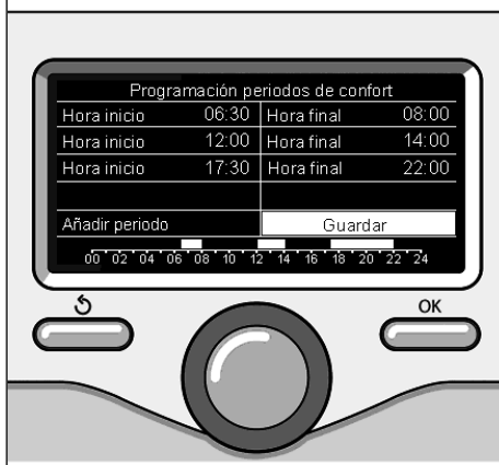
Programar períodos confort programación horaria calefacción
