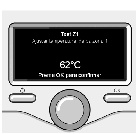
Modificação temperatura água quente aquecimento
