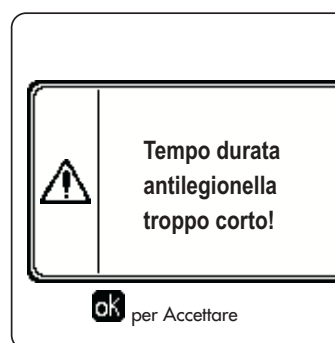
fig. 26 - Messaggio Funzione antilegionella non conclusa
