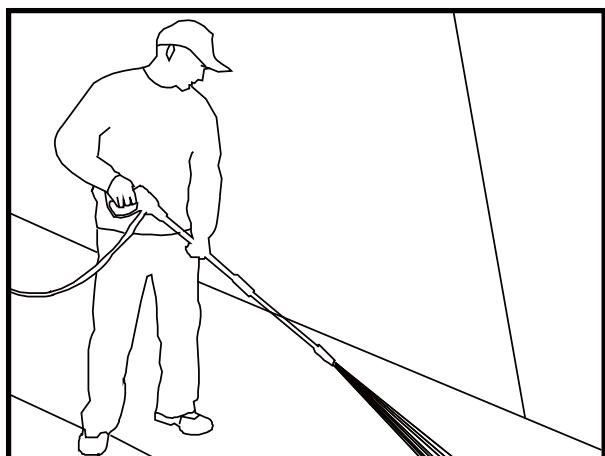
Imagem 6 - Ângulo óptimo para a superfície a ser limpa
