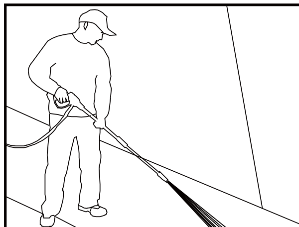
Figura 6 – Angolo di pulizia ottimale
