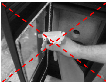
Figura 37 - Limpeza incorreta do vidro
