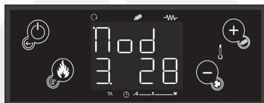
A estufa deteta que o calor gerado não pode permutá-lo por completo, pelo que entra em estado de modulação para garantir uma permutação máxima, o máximo rendimento e uma poupança de combustível.
