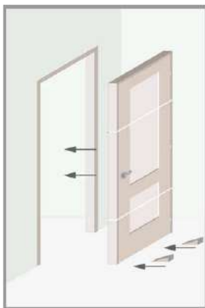
Figura 2. Colocação de Bloco da Porta
