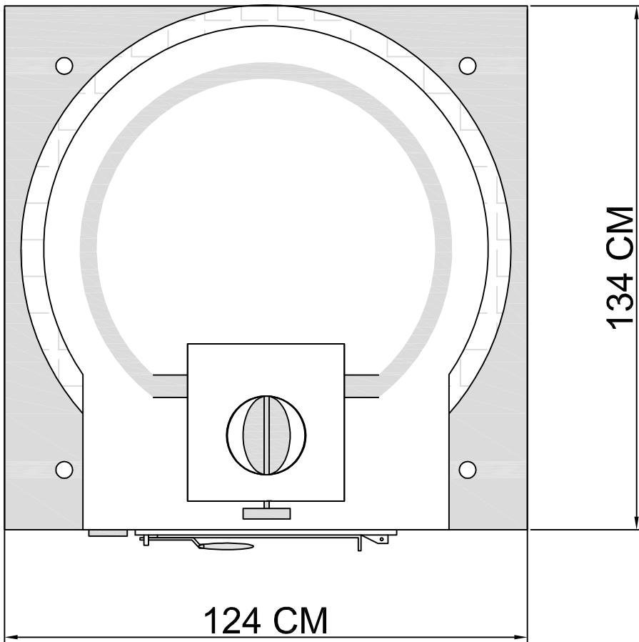
Plataformas de Hormigón Armado con 4 Cancamos Ø16mm - Espesor de la Placa 5 cm - Bordes Biselados - Color Crema
