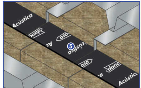
5 Cubiertas acústicas tipo deck (entre material aislante)
