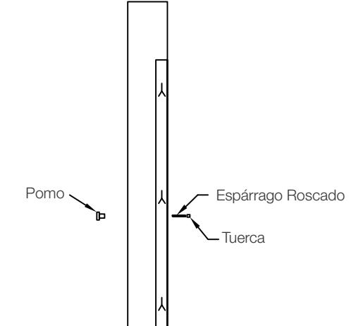
Colocar el pomo por la parte exterior, enroscándole el espárrago a través de la hoja, fijándolo con su correspondiente tuerca.
