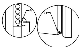
Utilizar el Regulador del Resbalón (4) para evitar el movimiento de la puerta una vez cerrada. Regular el Cepillo Guillotina / Cortavientos (5). (Solo en modelos dotados de este sistema)
