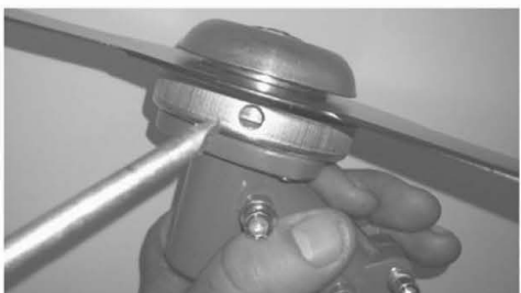
Colocação da chave L no orifício lateral da cabeça para prender o eixo de suporte do disco.
