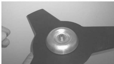
Taça metálica de proteção colocada.
