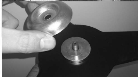
Colocación de la taza de protección.
