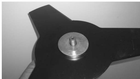
Arandela de fijación del disco puesta para fijar el disco.
