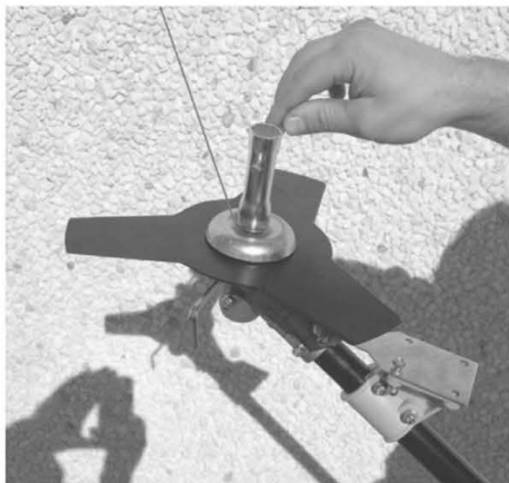
Porca de aperto para a esquerda (sentido contrário aos ponteiros do relógio)
