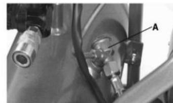
5) VÁLVULA DE SEGURANÇA: Esta válvula é projetado para evitar falhas no sistema , aliviando a pressão do sistema de ar comprimido , quando atinge um nível pré-determinado. A válvula é pré-definida pelo fabricante e não alterados de forma alguma .
