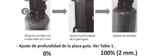
4. Cómo ajustar la profundidad de la placa guía para evitar marcas en la madera.
