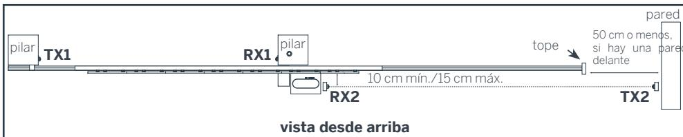
Al conectar las photocélulas de esta forma, el sistema reacciona cuando se produce un corte de alguno de los haces por infrarrojos durante el cierre y del haz del borde secundario durante la apertura. Es
