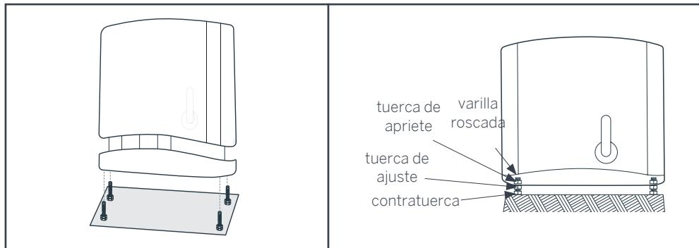
Cuando el motor esté bien horizontal, apriete las tuercas para bloquear la tuerca de apriete, después ajuste las tuercas de apriete para mantener el motor en posición.
