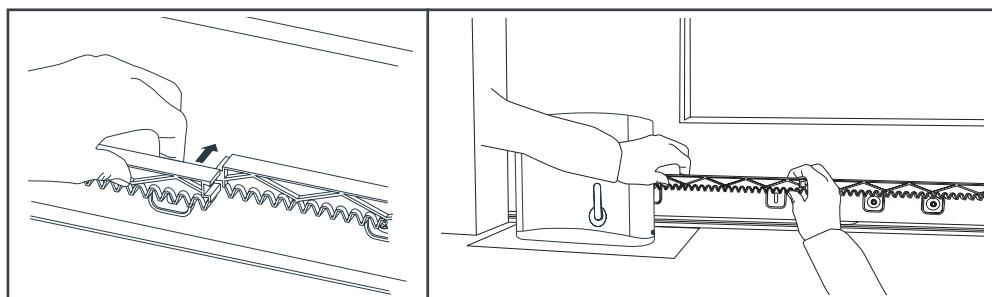
Compruebe que toda la cremallera est  centrada respecto a la rueda dentada del motor. Si no fuera el caso, ajuste la posici n del motor en su base.
