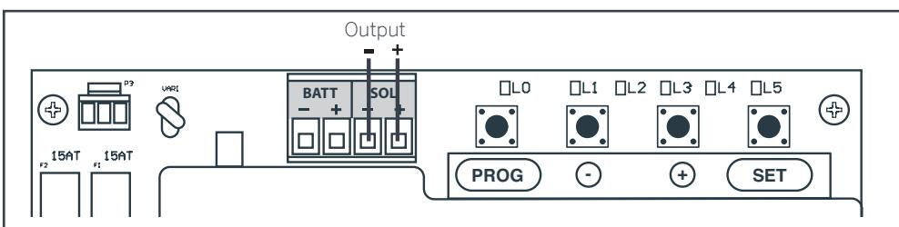
1. Conectar la motorización a la regleta de terminales «OUTPUT» mediante un cable de 2 x 1,5 mm<sup>2</sup>,
