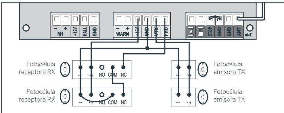
Protección bordes primarios y secundarios: en el caso anterior, el segundo juego no puede montarse para proteger el borde secundario de la cancela durante la apertura. Para este tipo de funcionamiento, conecte el segundo juego de photocélulas a la entrada «arrêt d'urgence» (parada de emergencia) como se muestra a continuación:
