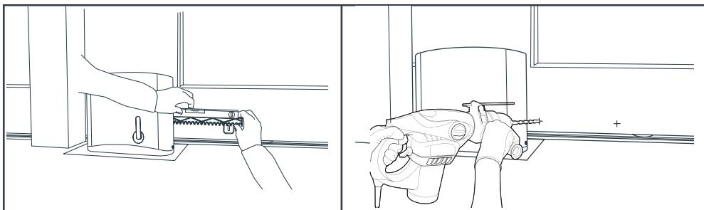
La cremallera debe estar perfectamente horizontal, use un nivel en caso necesario. Deje una distancia de 1 a 2 mm como máximo entre la cremallera y la rueda dentada del motorreductor.
