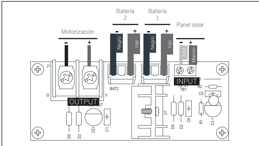
2. Conecte el panel solar a la regleta de terminales verde «INPUT». Respete la polaridad y siga escrupulosamente el esquema de conexión.
