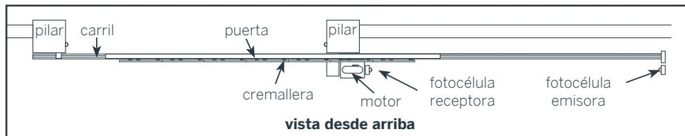
El corte del haz de las photocélulas debe provocar la parada de emergencia de la cancela. En este caso, la salida normalmente cerrada de la photocélula receptora (RX) debe estar conectada a la entrada **STOP** de la tarjeta electrónica.
