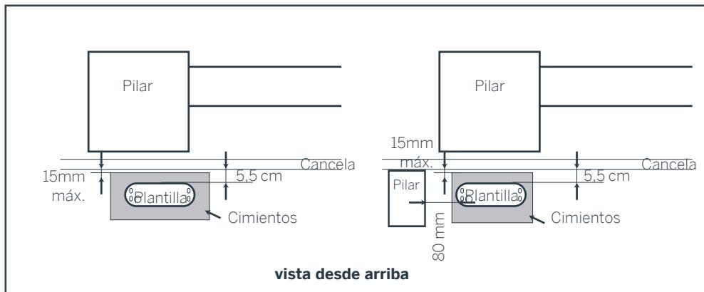
El paso de los cables debe cumplir con las normas vigentes (NFC 15-100). El cable se encuentra a 80 cm de profundidad con rejilla de señalización roja o se pasa en una vaina. Coloque la vaina de paso de cable, así como los pasadores de fijación al suelo tal como se indica en el esquema siguiente antes de verter el hormigón:
