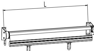
2. Avvitare i ganci di fissaggio al muro o al soffitto, secondo le vs. esigenze, come illustrato.
