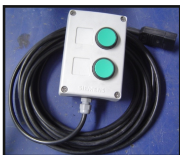
Figura 14: Cabos de ligação e caixa de comando exterior
