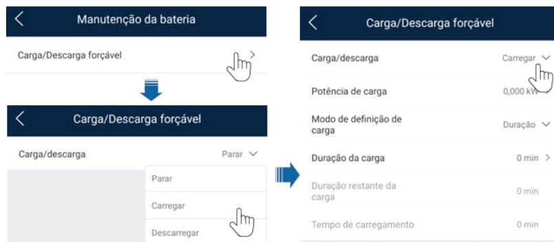
Figura 6-6 Carga e descarga forçada
