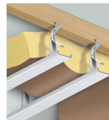
Puoi approfittare del lavoro di controsoffittatura per inserire un pannello isolante, all'interno delle lastre. Nel caso, ricordati di indossare **guanti e maschera**.
