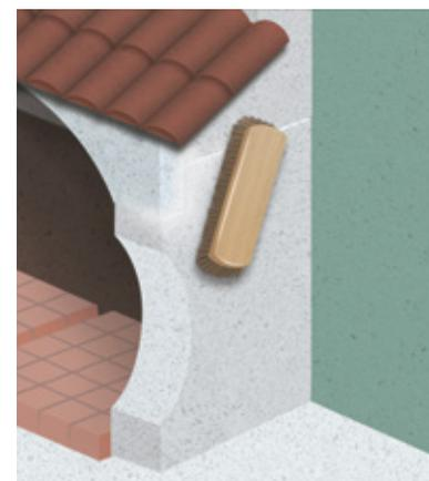
Strofina le zone dei giunti con una spazzola multiuso, ben bagnata. Infine, passa bene una spugna inumidita. **Aspetta 48 ore per dare la prima fiammata**, per permettere agli elementi in muratura di asciugarsi bene. Per ragioni di sicurezza, non utilizzare alcol o altro liquido infiammabile per accendere o riattivare il fuoco.
