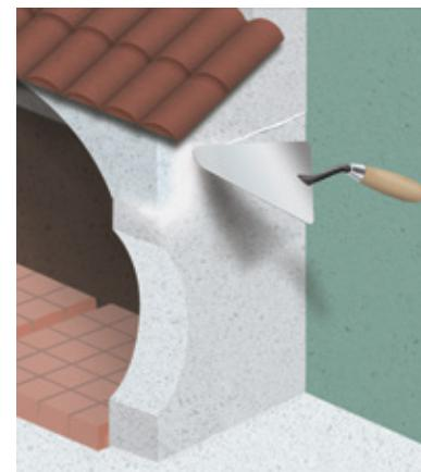
Realizza i **giunti** con la malta refrattaria preimpastata. Riempi con l'impasto tutti i giunti con la punta del cazzuolino, gratta l'eccesso senza aspettare che faccia presa.
