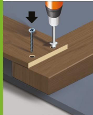
Fresa i fori per incassare **la testa della vite**, inserisci le viti e avvitalo con il trapano.
