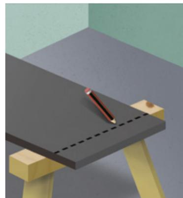
Posiziona il **piano capovolto** sui cavalletti. Riporta la misura rilevata e traccia con la squadra le linee di taglio.
