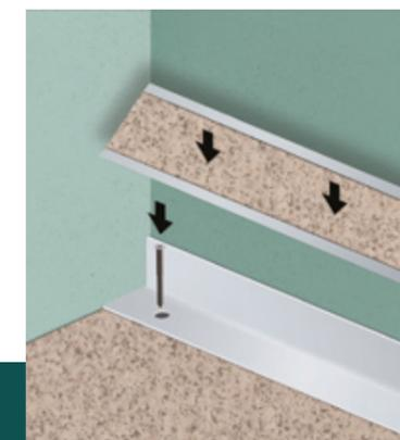
Fissa il supporto avvitandolo al piano. Applica la **finitura** premendola al supporto.
