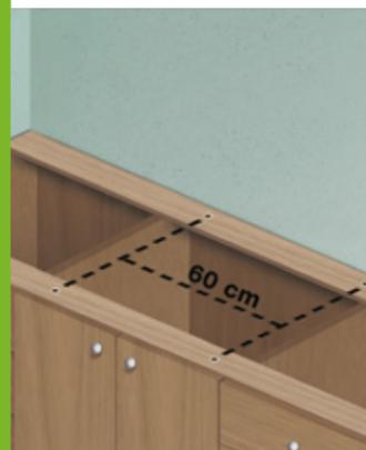
Avvita il piano al mobile: fora con una punta per legno ogni 60 cm circa **sul lato anteriore e posteriore** della struttura del mobile.
