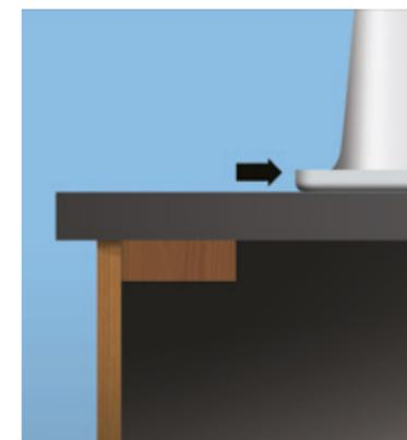
Spingi il lavello o il piano di cottura il più possibile **verso la parte posteriore**, per evitare di dover tagliare la traversa. Lascia tra il lavello e il muro lo spazio necessario per montare l'alzatina ferma acqua.
