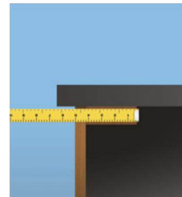
**Sotto il piano cucina**, misura la distanza tra il bordo del piano stesso e il bordo interno della traversa del mobile.
