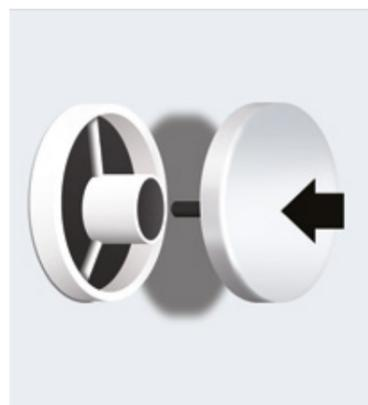
Fissa il **comando del troppo pieno** (parte interna del tubo di scarico) sul lato interno della vasca, in corrispondenza del foro.
