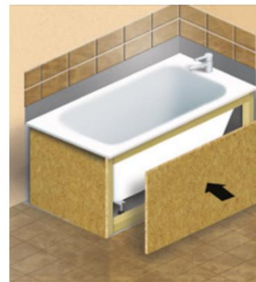
Chiudi con i pannelli i **lati visibili** della vasca. Puoi anche utilizzare blocchi di cemento cellulare, pannelli già piastrellati o pannelli di legno truciolare idrorepellente da 16 millimetri.
