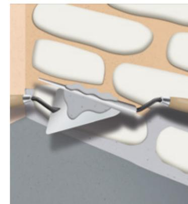
Prepara lo stucco per fughe dopo qualche ora, seguendo le **avvertenze del produttore**. Spingi l'impasto dentro la fuga con un riempifughe o un ferro per fughe. Puoi anche utilizzare un "sac à poche" da pasticciere. Aspetta che il prodotto vada in presa, poi liscia facendo una leggera pressione.
