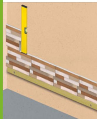
Inizia una fila su due con un pezzo tagliato a metà, se vuoi un rivestimento a **giunti sfalsati**. Traccia delle linee verticali sul muro con la livella, per controllare l'allineamento.
