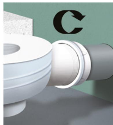
Inserisci la **guarnizione e qualche giro di nastro isolante** sulla filettatura della piletta sifonata. Collegala al tubo di scarico. Verifica dopo un'ora la **tenuta stagna**.
