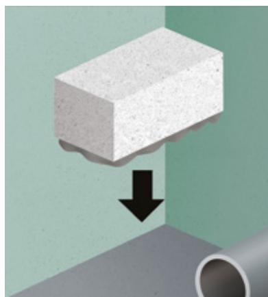
Fissa i quattro blocchi. Ricordati che questo passaggio non è necessario se il piatto è provvisto di **piedini regolabili**.
