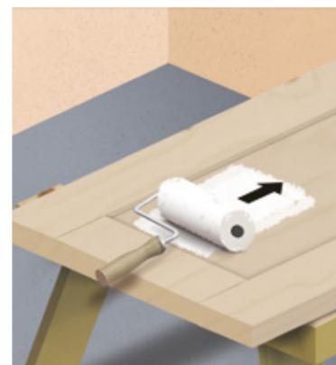
Applica la vernice **sulle superfici piane** utilizzando un rullo medio. Distribuisci bene la vernice sulla superficie, procedendo sempre **nel senso delle venature** del legno.
