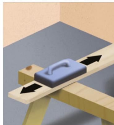
Aspetta che sia asciutto e leviga tutta la superficie, muovendoti **nel senso delle venature del legno**.
