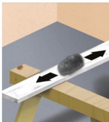
Rimuovi più sverniciatore possibile con la spatola e aspetta che le **parti siano asciutte**. A questo punto, pulisci a fondo la superficie con **lana d'acciaio** per togliere dal legno gli ultimi residui di vernice.
