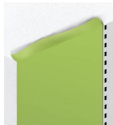
Posa il primo telo: appoggialo sul bordo del muro lasciando in alto un'**eccedenza di 5 cm**. Verifica che cada a piombo su tutta l'altezza del muro, facendo riferimento alle linee tracciate.
