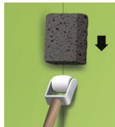
Passa il rullo in gomma per parati **sulla giunzione** dei due teli. Passa anche una spugna inumidita per eliminare la colla in eccesso.
