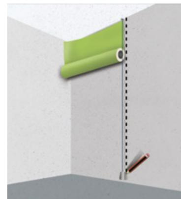
Cala il filo a piombo, traccia le **lineette di riferimento** sul muro e fai coincidere il telo con questa traccia.
