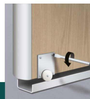
Svita o avvita leggermente le apposite viti per regolare il meccanismo di scorrimento. Se necessario, regola la posizione di ogni anta in modo che sia perfettamente a piombo o allineata al muro.
