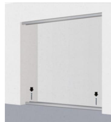
Riposiziona la guida e fissala, con le apposite viti, al pavimento.
