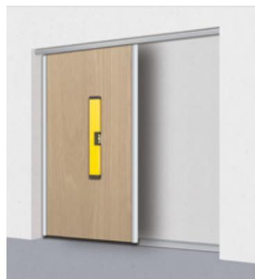
Verifica che l'anta sia a piombo; se necessario, sposta la guida.
