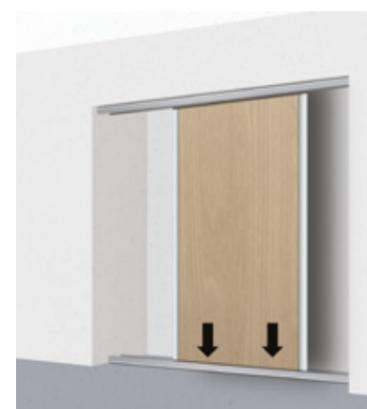
Inserisci l'anta posteriore. Falla scendere in modo che le rotelle vadano ad appoggiarsi sulla via di scorrimento posteriore.
