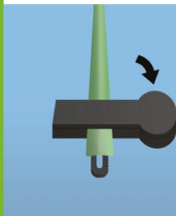
Sistema la guida, regola la **distanza di taglio**, fai scivolare l'estremità della lamella fino al punto giusto e abbassa la lama.
