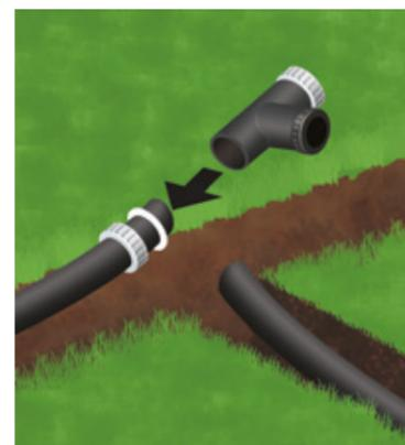
Installa un **raccordo tee**: fai scivolare il dado e l'anello sul tubo, spingi il tubo nel raccordo e avvita il dado.
