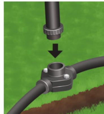
Fai un **foro nel tubo** con una punta da 10 mm, avvita la prolunga a segmenti e l'irrigatore, aggiungendo il **nastro di teflon**.
