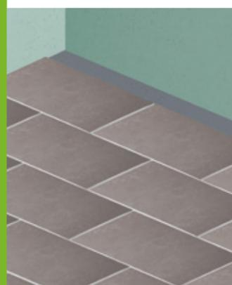
Completa anche la **seconda fila di piastrelle**. Rimuovi subito eventuali tracce di colla con una spugna umida, sciacquata con frequenza. Procedi nello stesso modo con **le file successive**. Rimuovi i distanziatori prima di stuccare o lasciali affogati nel letto di colla.
