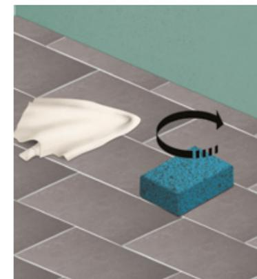
Quando il prodotto sarà quasi asciutto, passa delicatamente sulle piastrelle degli stracci puliti **con movimenti circolari**. Dopo circa 20 minuti passa una spugna umida, da sciacquare in acqua pulita. Lascia asciugare, poi ripassa con uno straccio.
