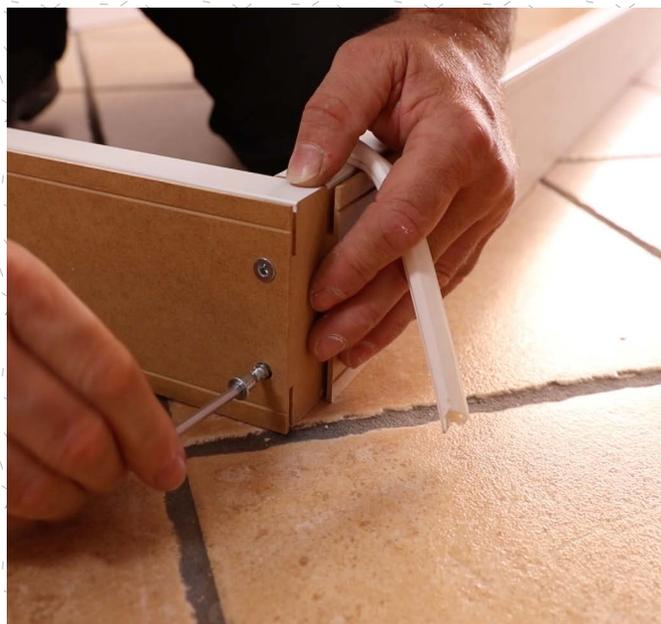
Inserisci le **viti** nei fori del telaio e stringile con la brugola fino in fondo.
